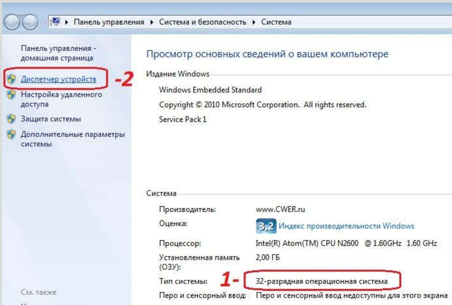
5) – На этом этапе до открытия или после открытия диспетчера устройств нужно подключить мотор-тестер DiaMag 2 через кабель к одному из USB портов. При этом в диспетчере устройств в категории «другие устройства» должно появиться устройство DIAMAG 2.
