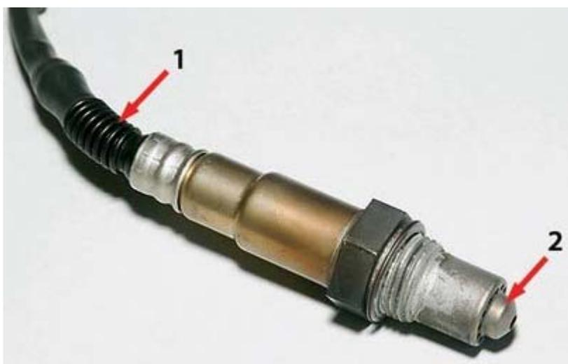
Новый датчик кислорода (лямбда-зонд) не подходит к прежним двигателям. Внешние признаки – гофрированный уплотнитель (1) и другой формы наконечник (2) с отверстиями.
