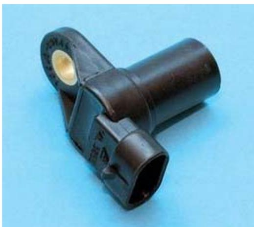
У двигателя 21114 фазированный впрыск топлива. Датчик фазы похож на датчик положения коленвала, но у него электроразъем с тремя контактами вместо двух и длина поменьше. С версией для двигателя 21124 невзаимозаменяем.
