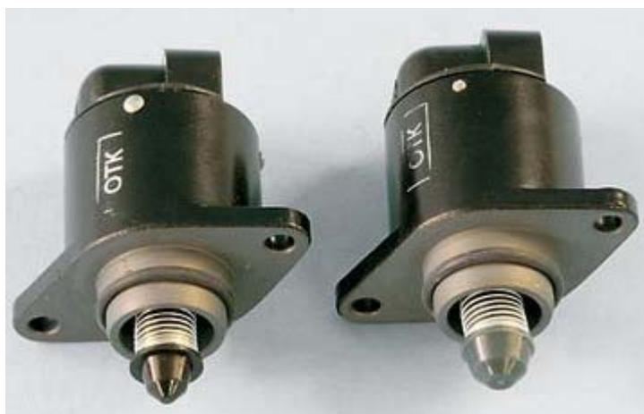
Регулятор холостого хода остался прежний, во избежание ошибок показываем рядом с ним справа регулятор для двигателя 21214 («Нива») рабочим объемом 1,7 л. Клапан «нивовского» больше.
