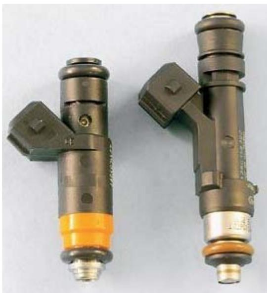
Топливные форсунки. Справа – двигателя 21114, одноструйные, слева – двухструйные, для двигателя 21124. С форсунками прежних моделей невзаимозаменяемы.
