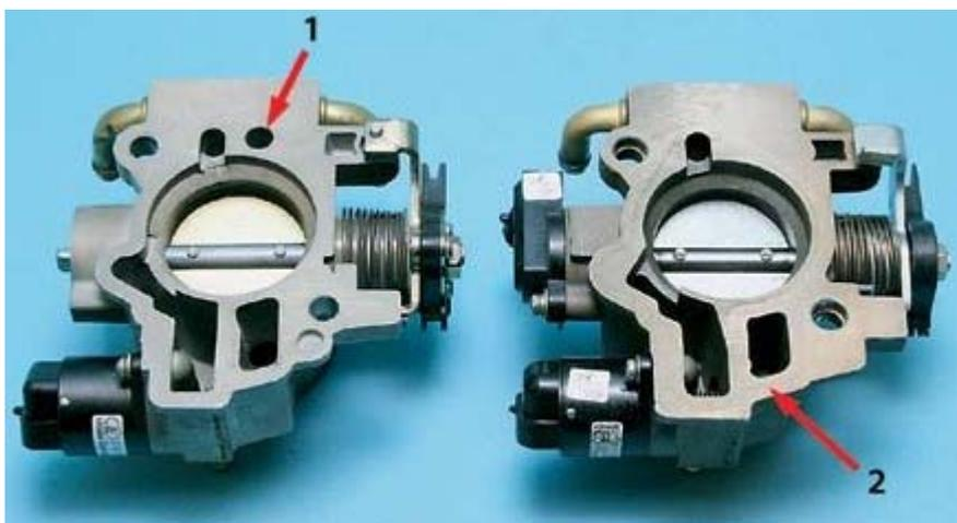
Важное изменение! В новом дроссельном патрубке (на фото справа) уже нет отверстия (1), соединяющего подводящий воздушный шланг с модулем впуска в обход дроссельной заслонки. Кроме того, изменена конфигурация фланца (2). Слева – узел для двигателя 2111.
