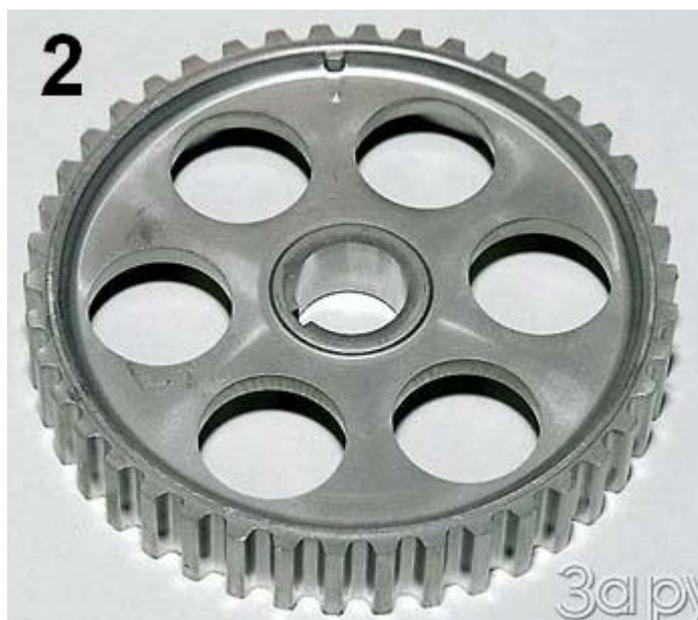
Шкивы распредвала двигателя 2111 (слева) и 21114 (справа). Взгляните на метку для установки фаз газораспределения при монтаже ремня. На шкиве 1,5-литрового двигателя она расположена посередине впадины между зубьями, а у 1,6-литрового смещена на два градуса.
