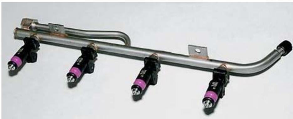
Топливная рампа двигателя 21124. Штуцер для проверки давления топлива выведен из-под впускного коллектора – доступ к нему удобней.
