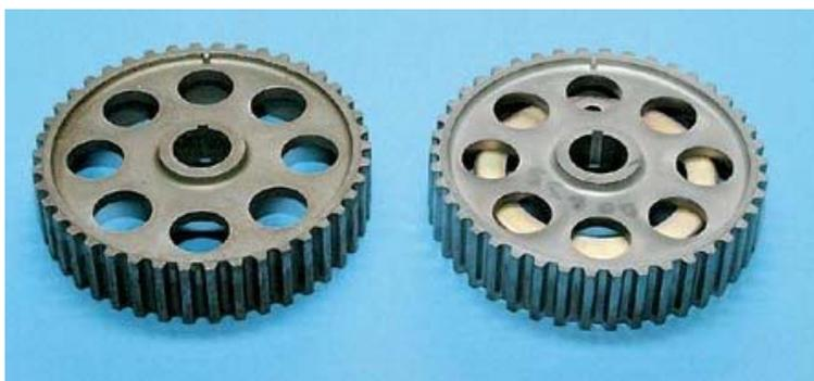
Точно так же – по расположению метки относительно зубьев – следует различать шкивы 16-клапанных моторов 1,5 и 1,6 л. В остальном они идентичны. А отличать впускной от выпускного совсем просто – на первом закреплен диск под датчик фазы.
