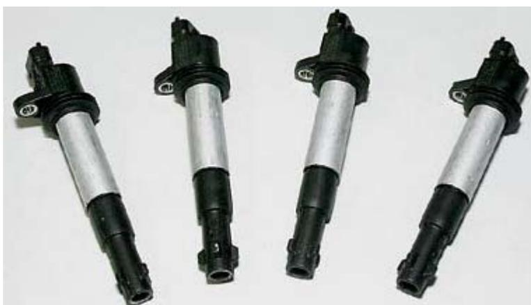
Индивидуальные катушки зажигания двигателя 21124, пришедшие на смену модулю зажигания и капризным высоковольтным проводам.
