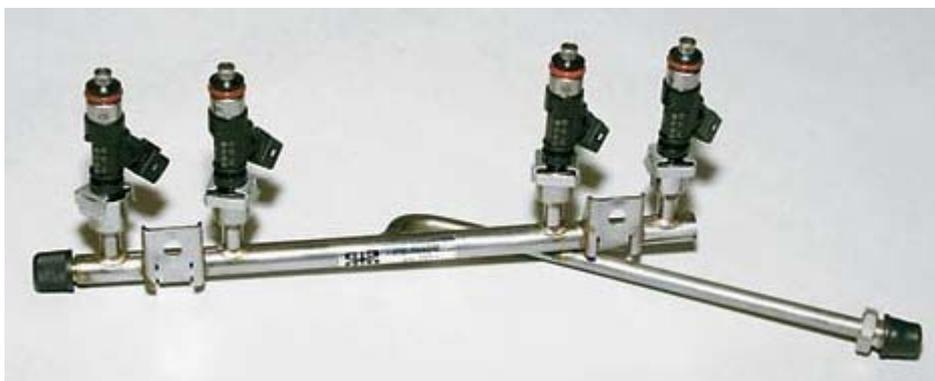
Компактная топливная рампа для двигателя 21114 из нержавеющей стали без магистрали слива топлива обратно в бак и регулятора давления. Заменяла прежнюю из алюминия.
