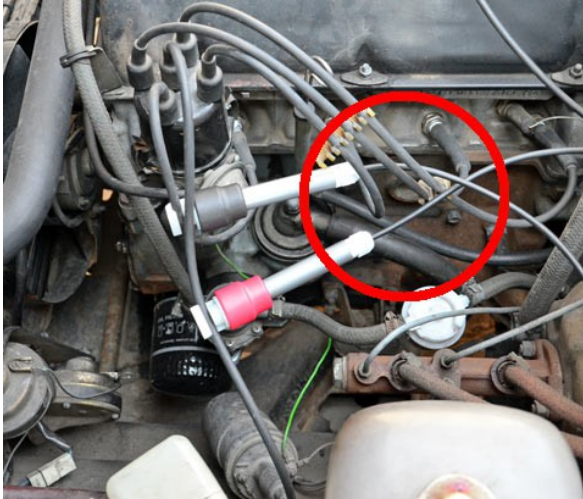
Неправильное расположение кабелей ёмкостных датчиков.
