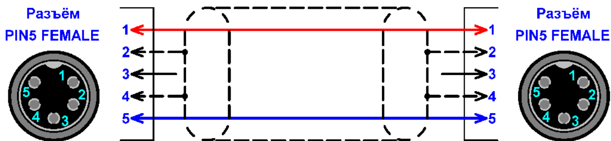
Схема распайки соединительного кабеля PIN5-PIN5 нового образца.
