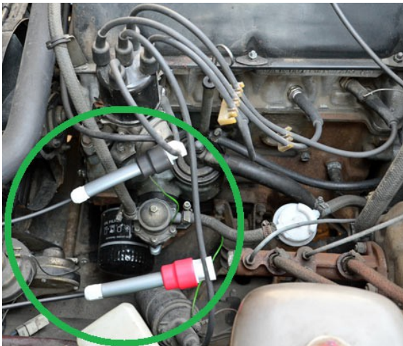
Правильное расположение кабелей ёмкостных датчиков.
