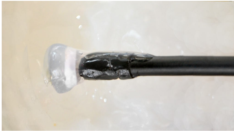
Ёмкостная пластина датчика Cx смазана диэлектрической смазкой.
