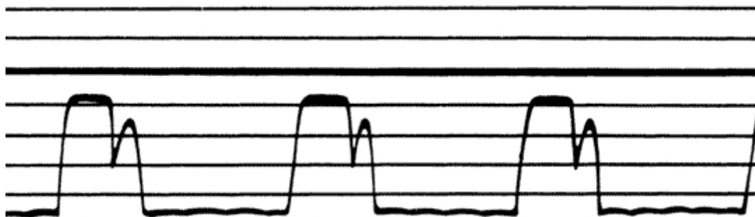
Обрыв цепи положительного диода соединённого с выводом "+" генератора.
